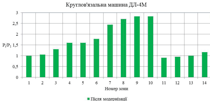
Рис.8.4.12. Діаграма зміни відносного натягу нитки у зонах заправки круглов'язальної машини ДЛ–4М після оптимізації форми лінії заправки
