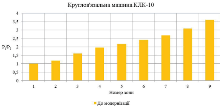
Рис.8.4.14. Діаграма зміни відносного натягу нитки у зонах заправки круглов’язальної машини КЛК – 10
