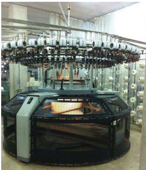
Рис.8.4.17. Форма лінії заправки ниток круглов'язальної машини Мауер
