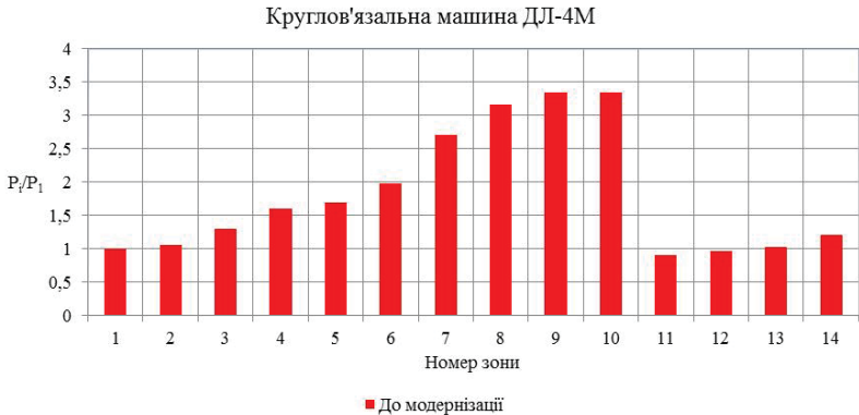
Рис.8.4.10. Діаграма зміни відносного натягу нитки у зонах заправки круглов'язальної машини ДЛ–4М
