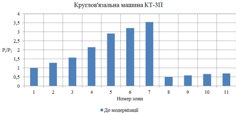
Рис.8.4.2. Діаграма зміни відносного натягу нитки у зонах заправки круглов'язальної машини КТ-3П
