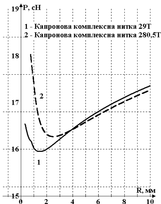
Рис.4.2.10. Залежність зміни натягу капронових комплексних ниток від радіуса кривизни напрямної
