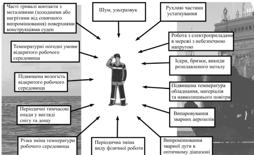
Рис. 2. Загальноприйняті шкідливі та небезпечні фактори виробничого середовища, що діють на зварників суднобудівної галузі
