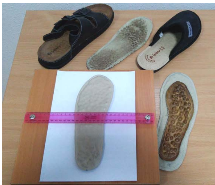
Рис. 3.9. Пристрій для вимірювання відстані між кісточками в масажній устілці
