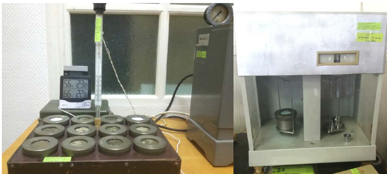
Рис. 5.6. Прилади для проведення дослідження на паропроникності та вологопоглинання
