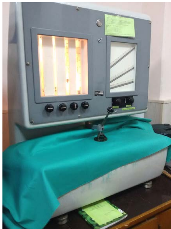
Рис. 5.1. Прилад для проведення дослідження на повітропроникність
