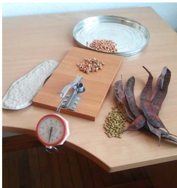
Рис. 3.6. Пристрій для визначення міцності кісточок плодкових рослин, підготовлений до роботи
