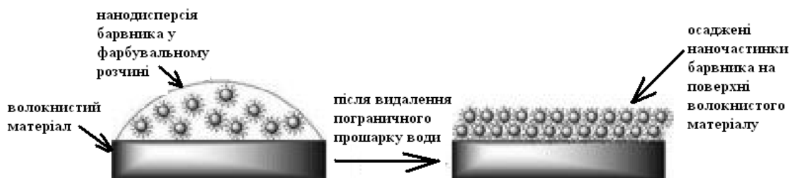
Рисунок 3 - Схема осадження наночастинок барвника на поверхню волокнистого матеріалу.
