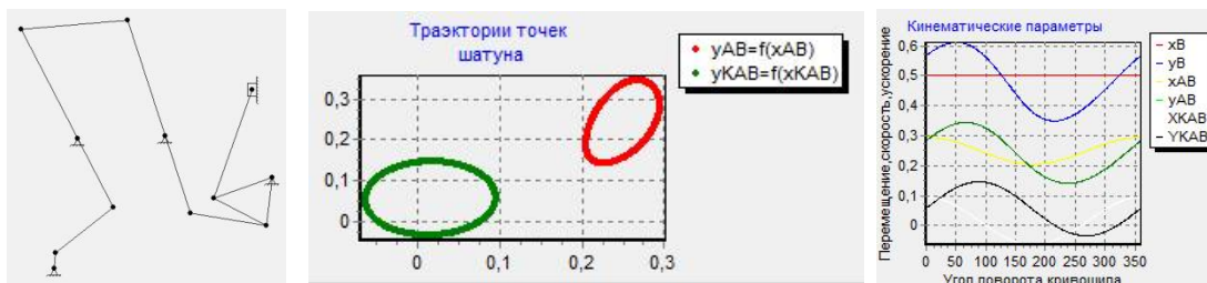
Рисунок 1 – Схема механізму переміщення основних ниток верстата PRM та основна форма програми
