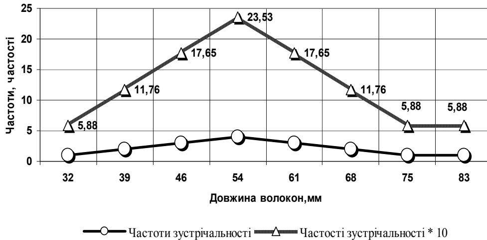
Рис. 5. Графіки частот та частостей зустрічальності довжин волокон, побудовані за результатами обробки штапельної діаграми за допомогою табличного процесора MS Excel
