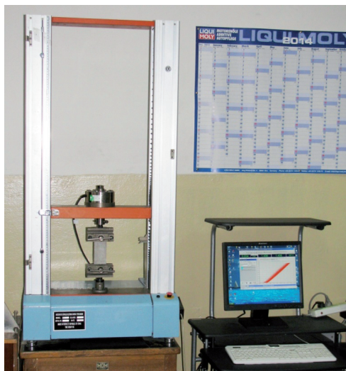
Рис. 1. Зовнішній вигляд розривної машини WDW-5E з програмним забезпеченням
