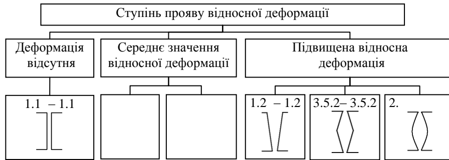
Рис. 2. Систематизація поєднань контурів за ступенем відносної деформації при з'єднанні деталей
