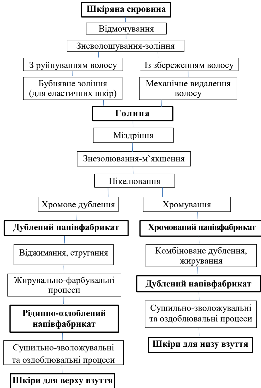
Рисунок 2.2 Схема виробництва шкір для верху та низу взуття
