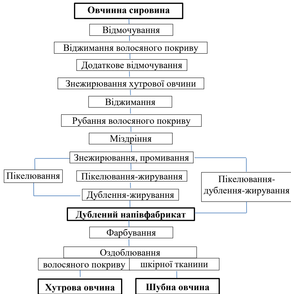
Рисунок 2.3 – Схеми виробництва хутрових і шубних овчин
