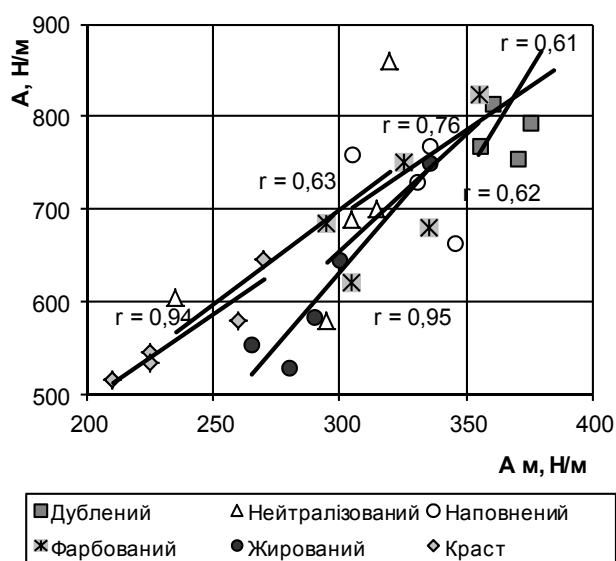
Рисунок 5.20 – Взаємозв'язок адгезії до сухої та мокрої шкіри на процесах обробки
