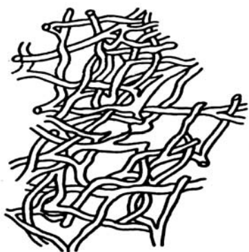
Рисунок 1.2 – Схема макроструктури дерми після зоління
