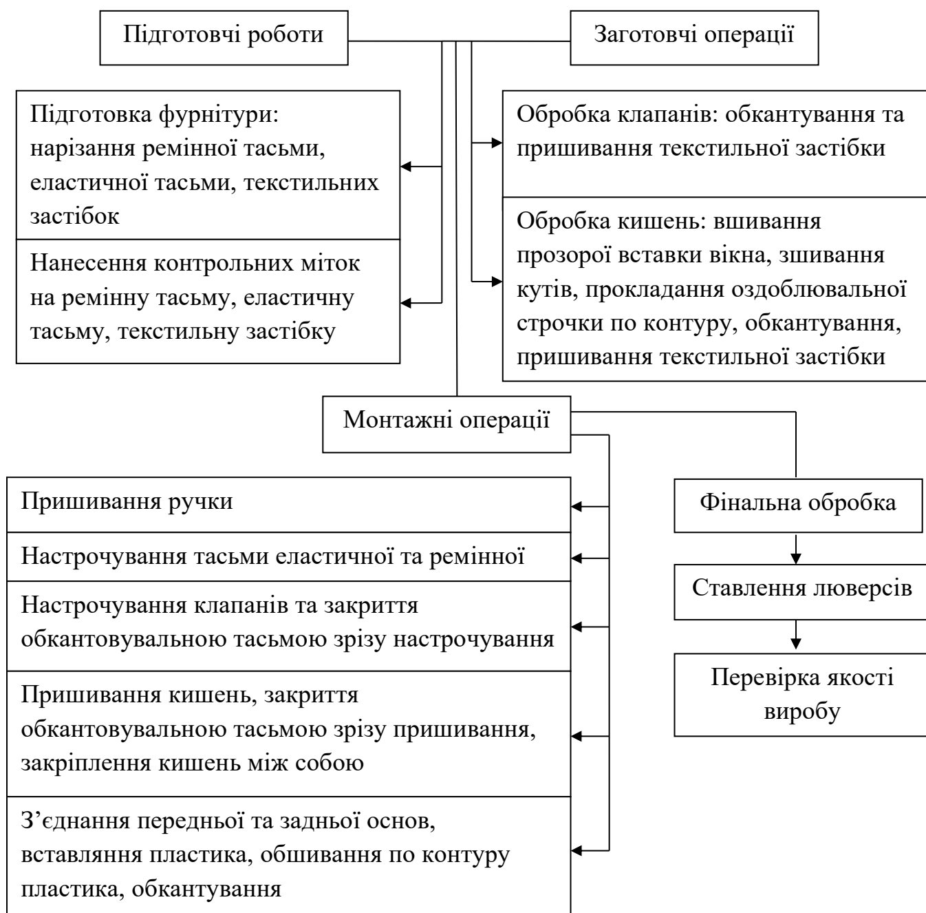
Рисунок 4.7. Загальна схема збирання медичної панелі-органайзера
