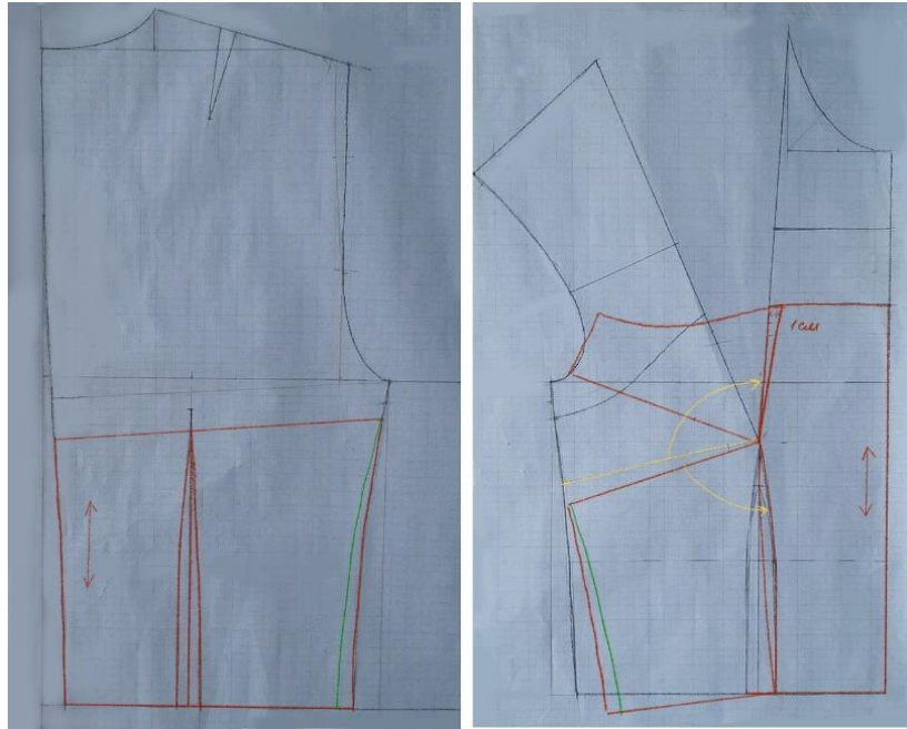
Рис. 3.13. Схема конструктивного моделювання низу ліфа (другий етап)
