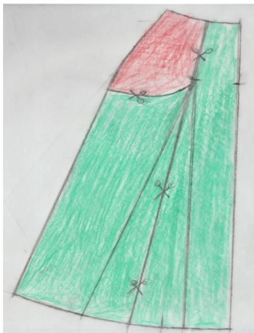
Рисунок 3.4 – Схема моделювання заднього полотнища спідниці базової моделі сукні жіночої. Джерела: розроблено автором
