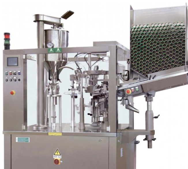
Рисунок 3.5 – Тубонаповнювальна машина ТНМ-50 («Промвіт, Україна»)
