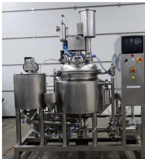
Рисунок 3.3 – Автоматична установка УПКП-70 («Промвіт, Україна) для виробництва м'яких форм
