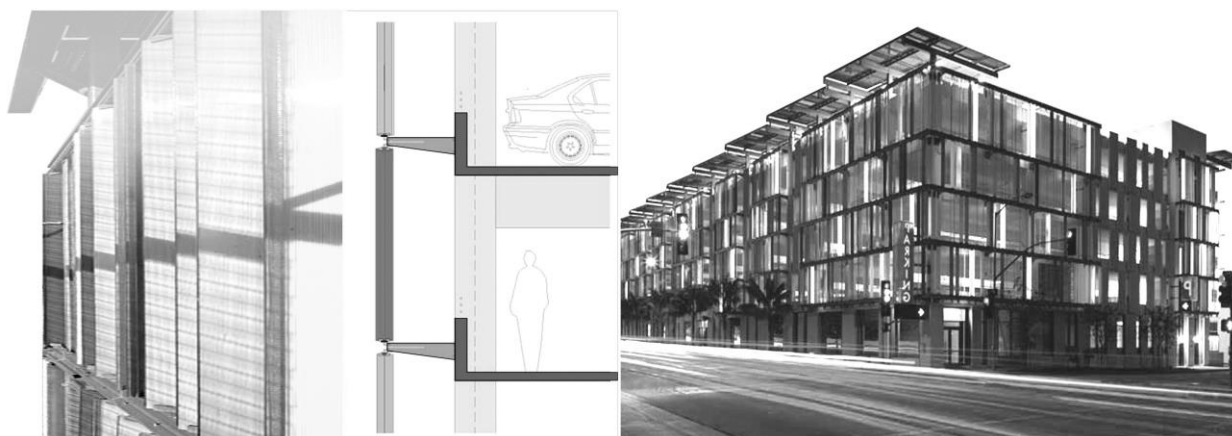
Рис. 3. Решение светопрозрачного структурного фасада МА «A Civic Gateway», Санта Моника, арх. «Moore Ruble Yudell Architects & Planners», 2006
