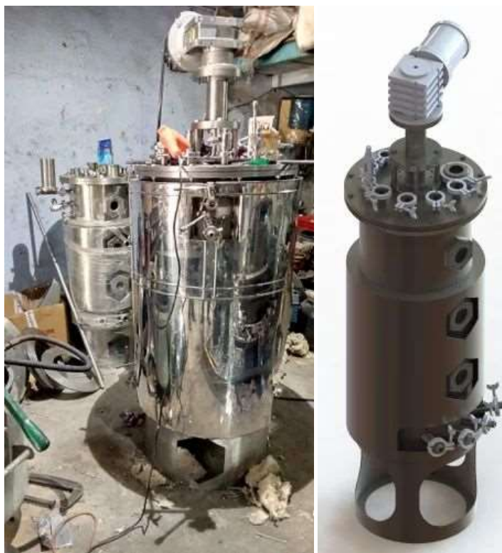
Рис. 2.1 Біореактор Insitu Fermenter на 3000 л «IndiaMART» (Індія)
