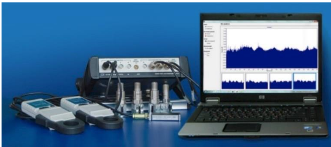
Рисунок 1 – Приклад реалізації вимірювальної системи струмів та напруг статорного кола АД
