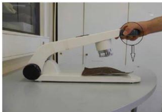
Рисунок 2.10 – Положення пробки на ЗВ та притискання верхнього важіля до повного блокування
