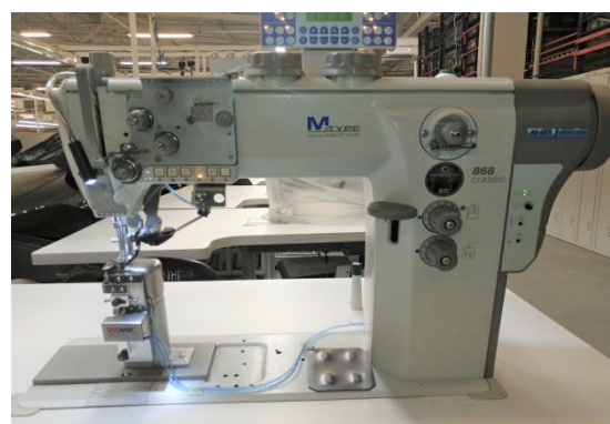
Рисунок 3.6 – Колонкова 1-голкова з додатковим засобом малої механізації (МК-Wulst-Naht) Durkopp Adler D-868-190322-M
