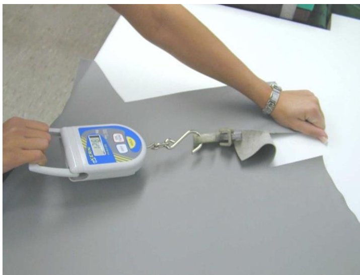
Рисунок 2.15 – Візуалізація процесу вимірювання сили розривання пружинною вагою
