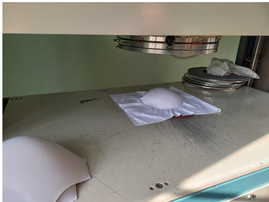
Рисунок 2.14 – ThermoТех РТ-Сompact 2. Термопрес, призначений для формування чашки бюстгальтера
