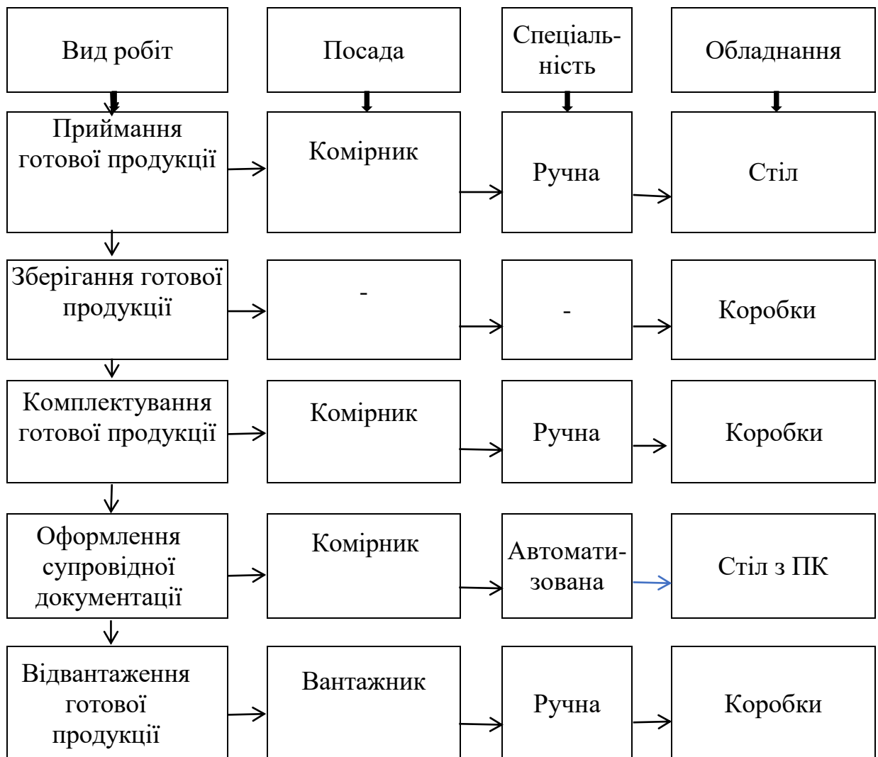
Рисунок 3.4 – Структурна схема технологічного процесу зберігання готової продукції.
