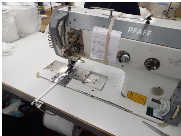
Рисунок 2.3 – Pfaff 1296. Двоголкова для пришивання каркасної стрічки
