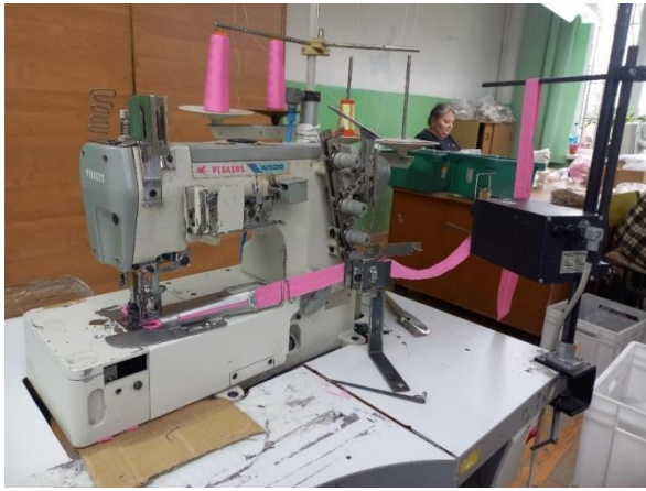
Рисунок 2.7. – Плоскошовна для обробки зрізів еластичною стрічкою
