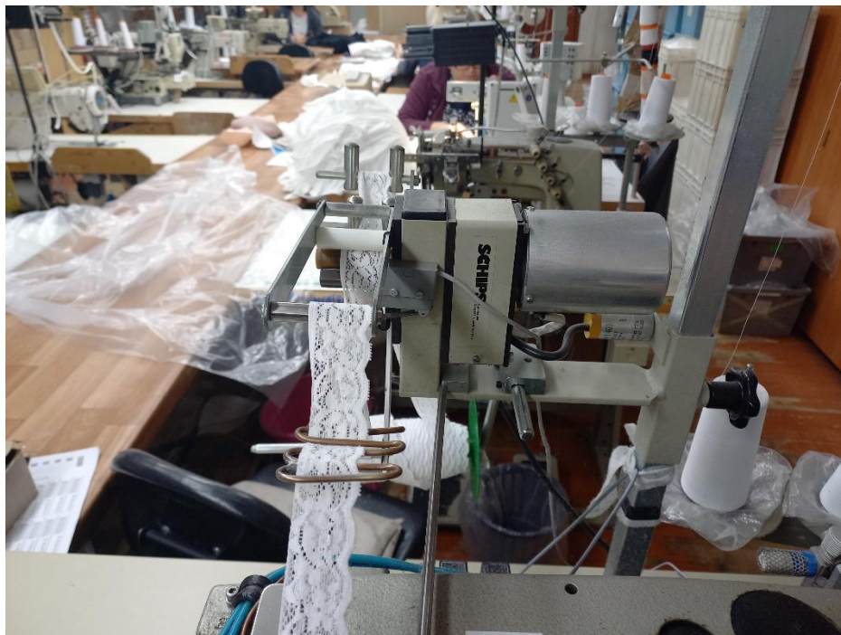
Рисунок 2.13 – Пристрій для подачі мережива чи еластичної тасьми
