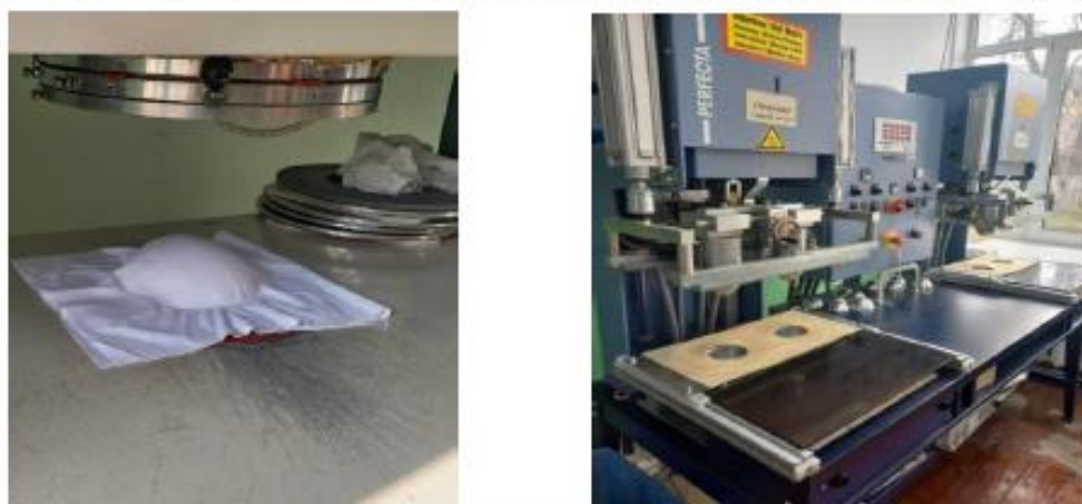
Рис. 2. Формування чашки бюстгальтера на термопресі ThermoTex PT-Compact 2
