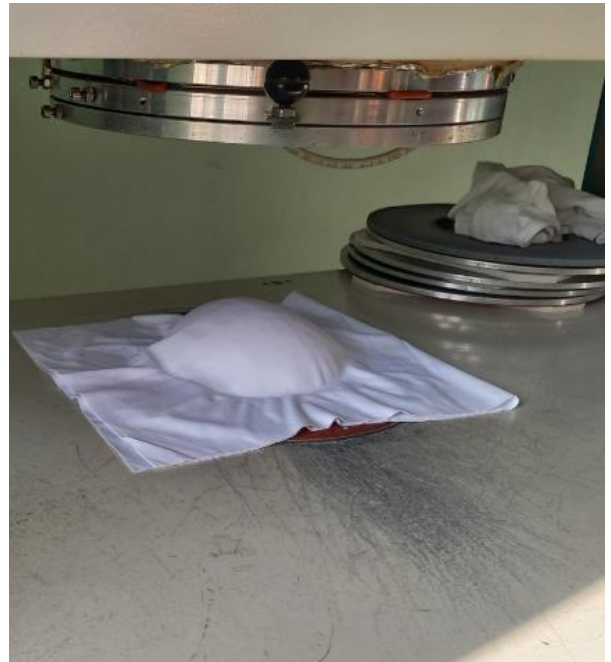
Рисунок 2.17 – Гладка формована чашка та процес формування верхньої чашки бюстгальтера на спеціальному пресі
