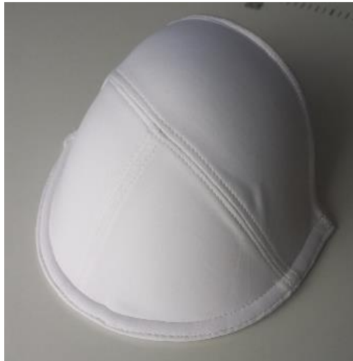
Рисунок 2.19 – Чашка з горизонтальним і вертикальним швами
