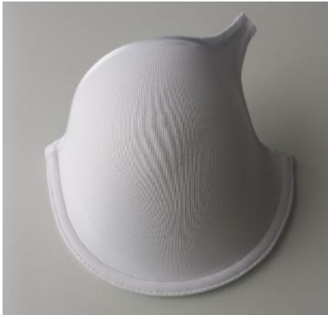
Рисунок 2.17 – Гладка формована чашка та процес формування верхньої чашки бюстгальтера на спеціальному пресі
