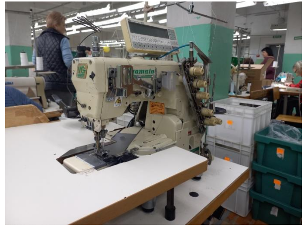
Рисунок 2.8 –Yamato VG2740PR-148S1 Двоголкова, для розстрочування швів
