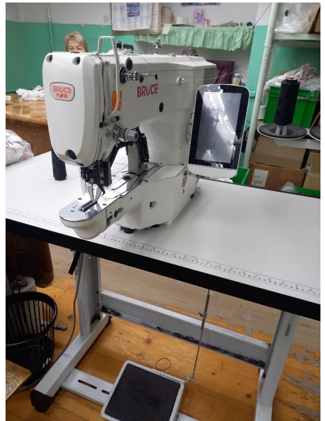
Рисунок 2.10 –Bruce T1900GSK-D закріпочна машина зі збільшеним робочим полем
