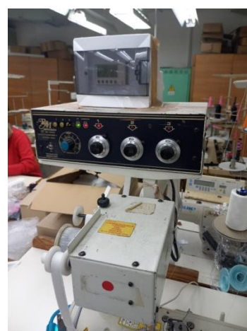
Рисунок 2.6 – Пристрій для подачі еластичної тасьми
