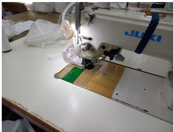
Рисунок 2.4 – Juki DLM-5400N-7 Одноголкова з ножем
