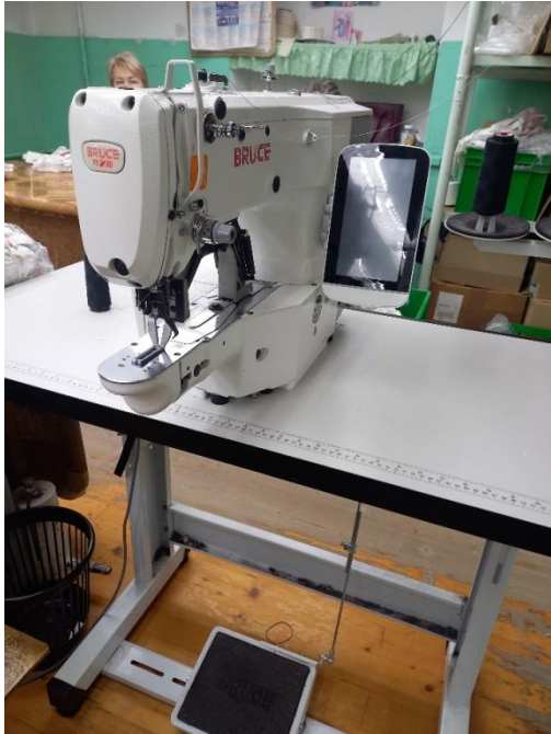
Рисунок 2.11 – Bruce T1900GSK- D закріпчна машина зі збільшеним робочим полем
