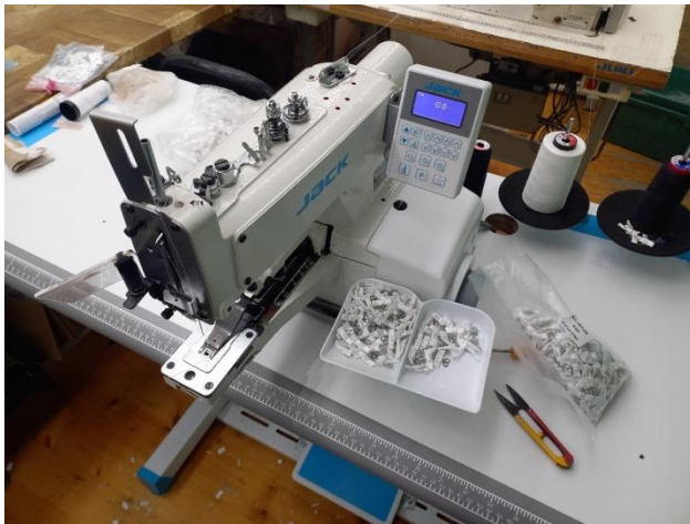
Рисунок 2.9– Jack-T1377E однонитковий гудзиковий напівавтомат
