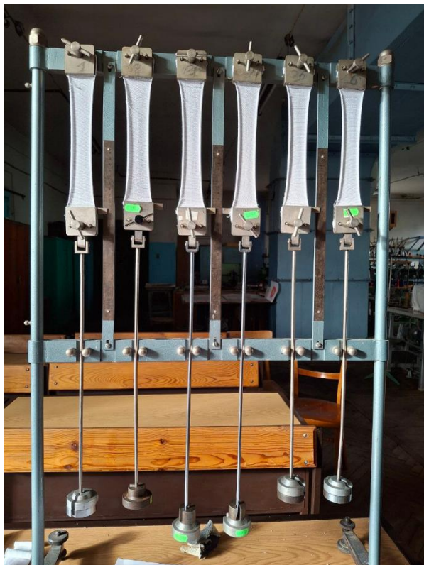
Рис. 2.1 Проведення дослідження деформаційних характеристик розроблених зразків трикотажних матеріалів досліджено у напрямку петельних рядів та петельних стовпчиків на релаксометрі типу «Стойка»
