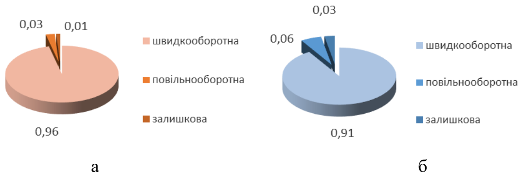
Рис. 4.26 Складові частки повної деформації трикотажного матеріалу, виробленого за щільності по вертикалі 10 пет. р. з рапортом прокладання еластомерної нитки 1+3 за швидкості обертання колеса, що подає еластомерну нитку 70 об/хв
