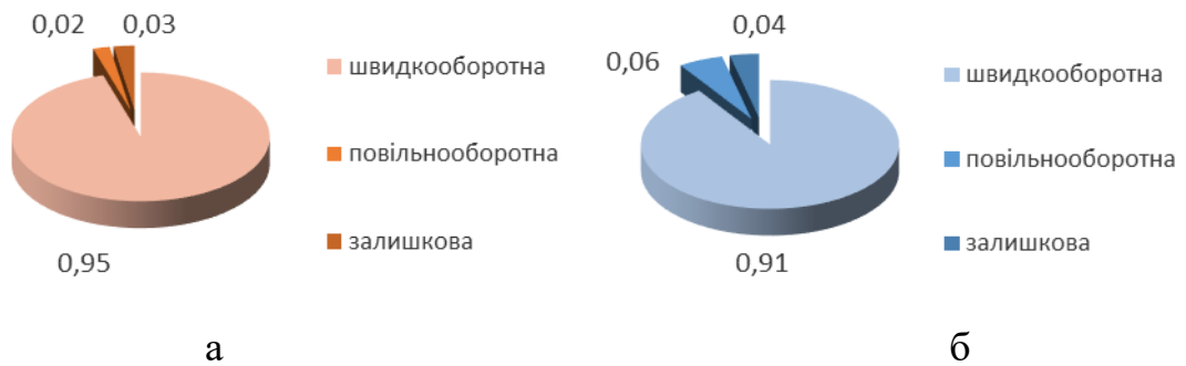
Рис. 4.23 Складові частки повної деформації трикотажного матеріалу, виробленого за щільності по вертикалі 9 пет. р. з рапортом прокладання еластомерної нитки 1+3 за швидкості обертання колеса, що подає еластомерну нитку 90 об/хв
