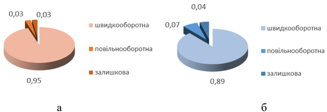
Рис. 4.9 Складові частки повної деформації трикотажного матеріалу, виробленого за щільності по вертикалі 9 пет. р. на 1 см з рапортом прокладання еластомерної нитки 1+1 за швидкості обертання колеса, що подає еластомерну нитку 50 об/хв
