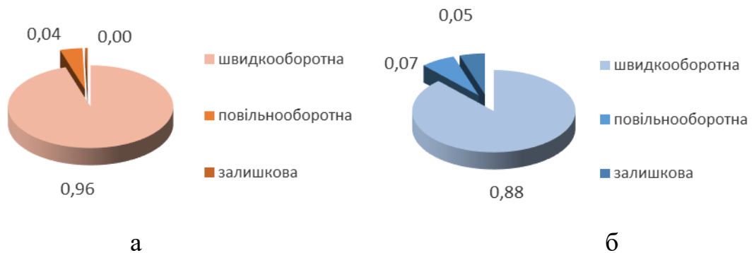
Рис. 4.18 Складові частки повної деформації трикотажного матеріалу, виробленого за щільності по вертикалі 11 пет. р. з рапортом прокладання еластомерної нитки 1+1 за швидкості обертання колеса, що подає еластомерну нитку 70 об/хв
