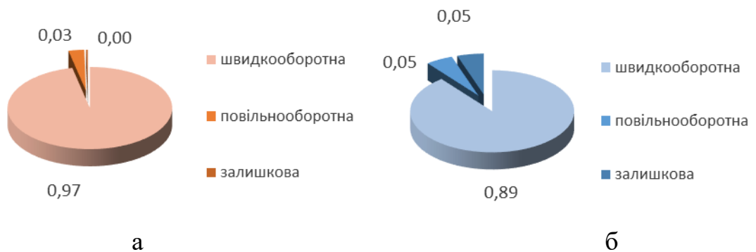
Рис. 4.15 Складові частки повної деформації трикотажного матеріалу, виробленого за щільності по вертикалі 10 пет. р. з рапортом прокладання еластомерної нитки 1+1 за швидкості обертання колеса, що подає еластомерну нитку 90 об/хв
