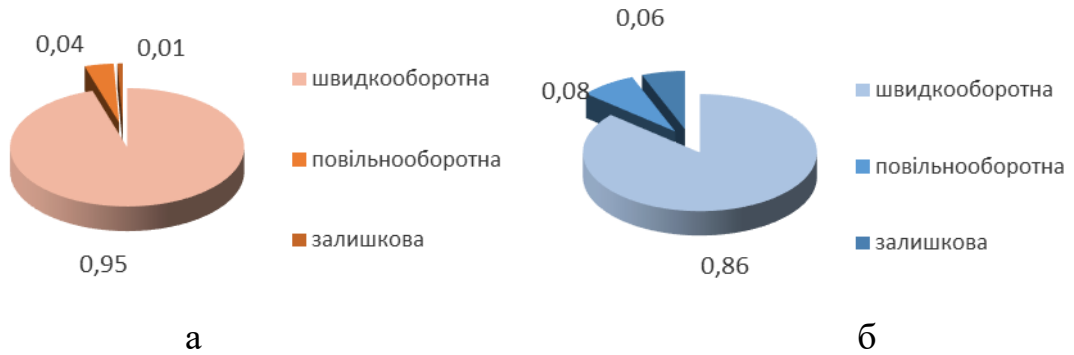
Рис. 4.19 Складові частки повної деформації трикотажного матеріалу, виробленого за щільності по вертикалі 11 пет. р. з рапортом прокладання еластомерної нитки 1+1 за швидкості обертання колеса, що подає еластомерну нитку 90 об/хв
