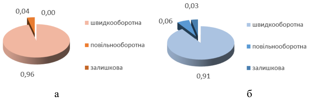
Рис. 4.29 Складові частки повної деформації трикотажного матеріалу, виробленого за щільності по вертикалі 11 пет. р. на 1 см з рапортом прокладання еластомерної нитки 1+3 за швидкості обертання колеса, що подає еластомерну нитку 50 об/хв
