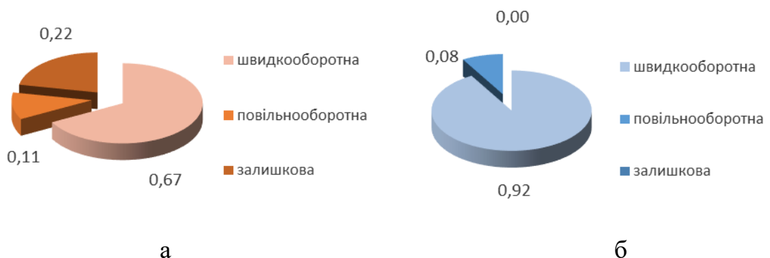
Рис. 3.19. Складові частки повної деформації трикотажного матеріалу, виробленого комбінованим переплетенням з льняної пряжі:
