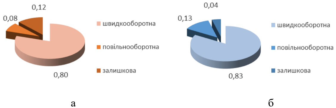
Рис. 3.15. Складові частки повної деформації трикотажного матеріалу, виробленого переплетенням ластик з кропив'яної пряжі:
