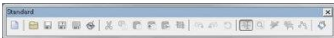
Рис.5 Панель Standard повторює основні пункти меню File і Edit, а також має набір з чотирьох різних типів курсору редагування.
