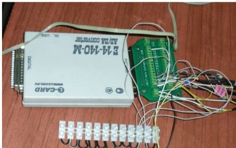
Рисунок 1. Зовнішній модуль АЦП E14-140M з клемником
