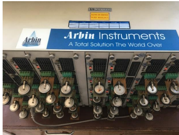
Рисунок 2.15 - Автоматична 32-канальна батарейна система ARBIN
