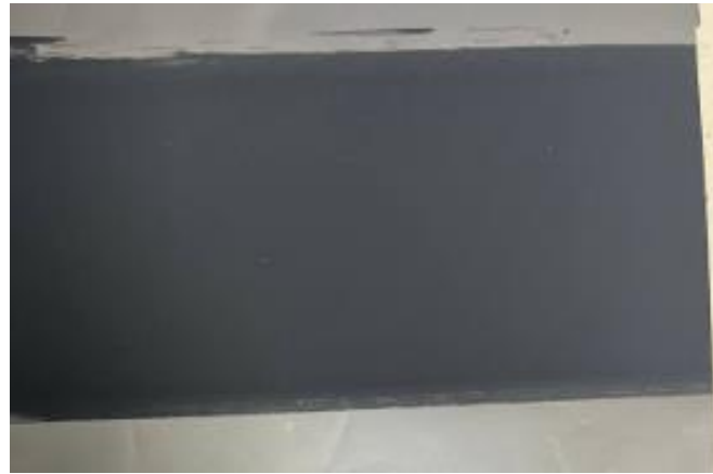
Рисунок 4.5 Зовнішній вигляд композитного електродного матеріалу на основі 85% YP-80F +10% Solef 6020
