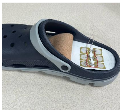
Рисунок 5.3 – Зовнішній вигляд прототипу п'єзоелектричного генератора в зразку взуття.
