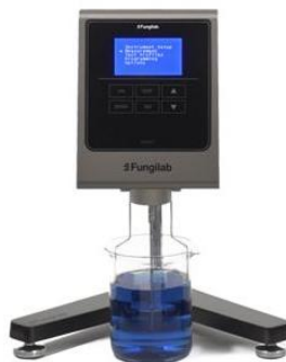
Рисунок 2.9 – Ротаційний віскозиметр Fungilab Alpha seri
