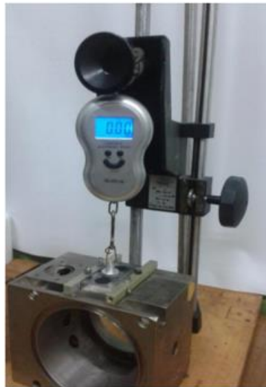
Рисунок 2.6 – Прилад для визначення адгезійної міцності по методу рівномірного відриву
