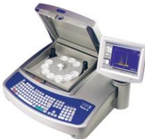
Рисунок 2.5 – Рентгенівський флуоресцентний аналізатор X-Supreme 8000 від компанії Oxford Instruments
