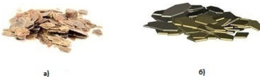
Рис. 1.12. а) частинки слюди плоскої форми; б) представлення частинок слюди у формі багатокутників для спрощення обрахунку МДЕ
