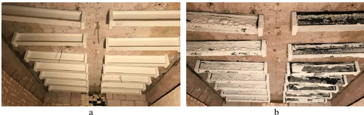
Рис. 5. Випробування двотаврових балок, захищених покриттями IC1 та IC6 з різними товщинами за DSTU В V.1.1-13:2007: а) до випробувань; б) після випробувань в умовах стандартної пожежі протягом 60 хв
