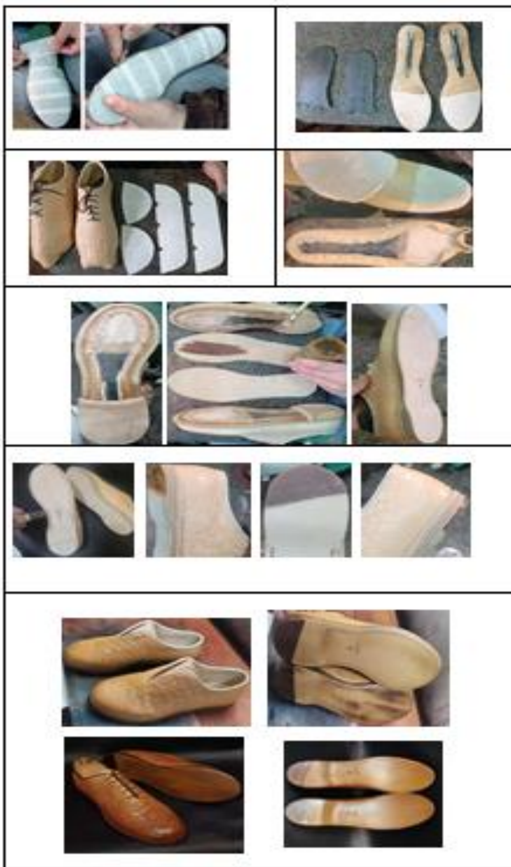
Рис. 3 Візуалізація етапів технології виготовлення та фінішного оздоблення чоловічого взуття за індивідуальним замовленням в стилі сучасна класика
