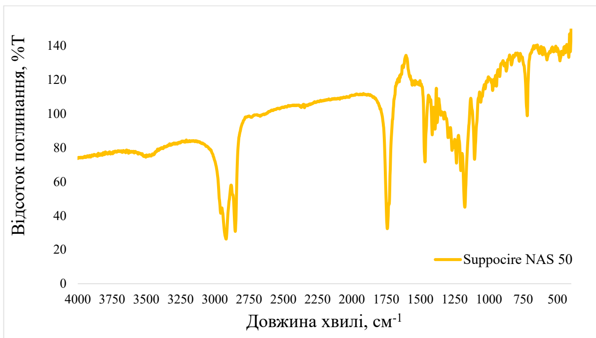
Рисунок 4.5 – FTIR-спектр твердого жиру Suprocire NAS 50
