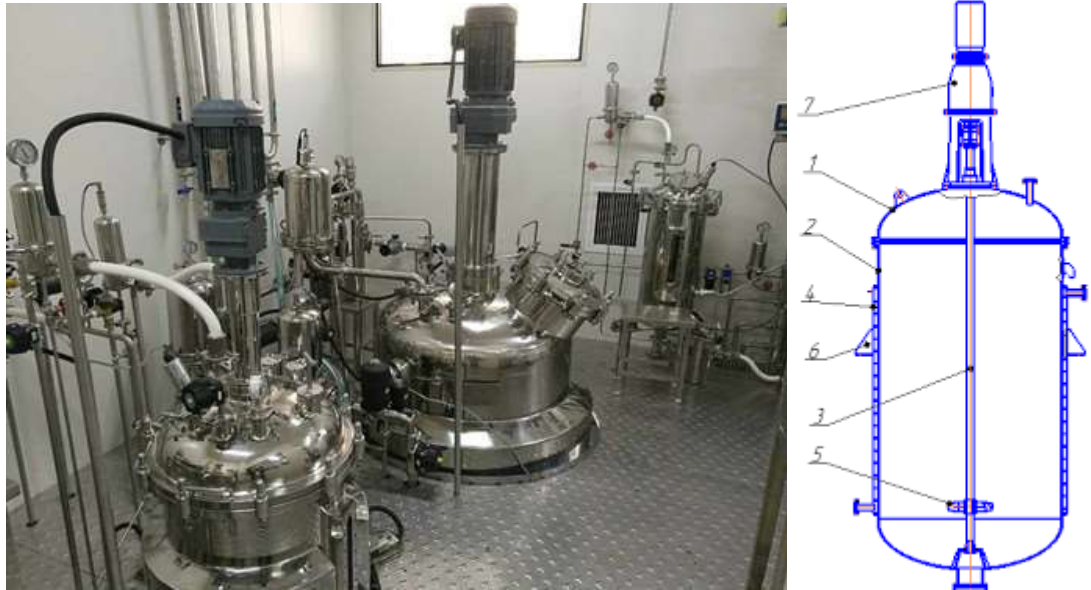
Рисунок 2.1 – Загальний вигляд та схема ферментеру: 1 – кришка; 2 – корпус; 3 – вал; 4 – сорочка; 5 – перемішуючий пристрій; 6 – опора, 7 – привід
