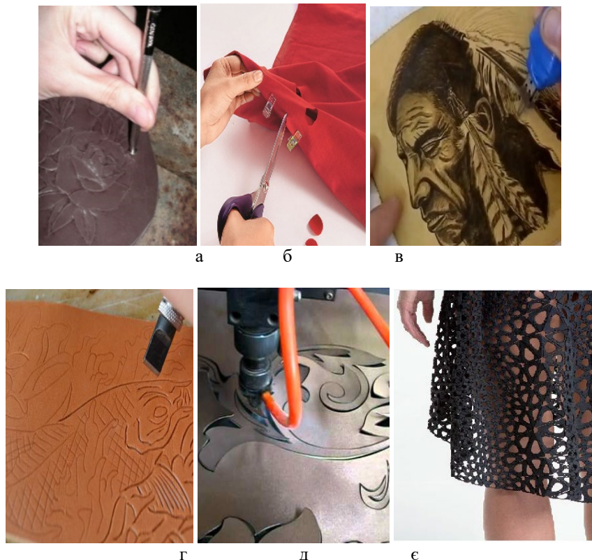
Рис. 3.17. Приклади виготовлення перфорації матеріалів різними способами: а – тиснення; б – ручна перфорація; в – пірографія; г – гравіювання; д – лазерна, є – 3D-друк
