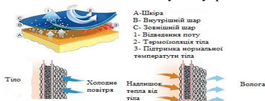
Рисунок 1 – Схема відведення вологи з внутрішньовзуттєвого простору
