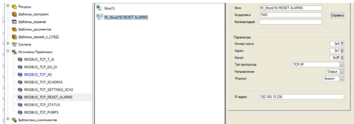
Рис. 3.18 група Modbus TCP Reset alarms
