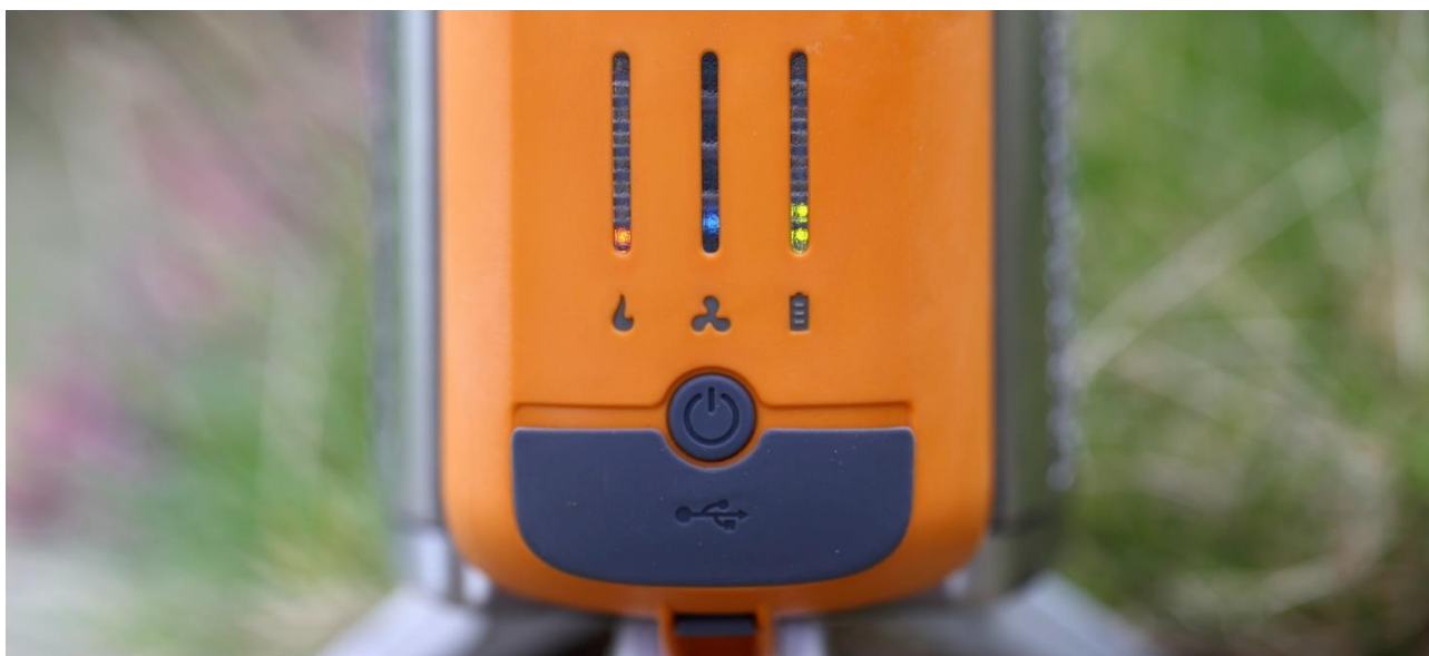
Рис. 3.23 - Загальний вигляд світлодіодної індикаторної панелі розташованої на блоці живлення
