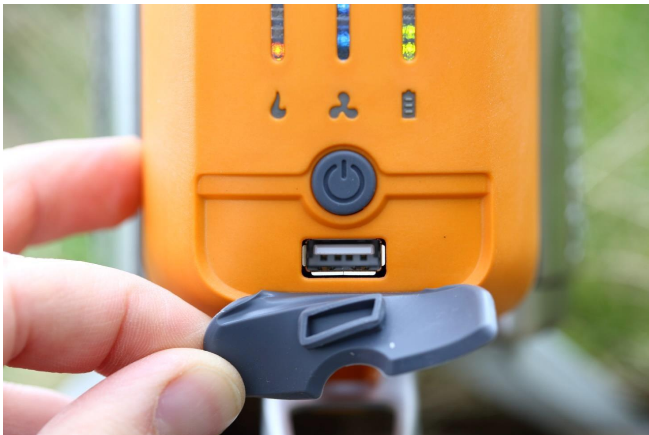
Рис. 3.22 - Вихід USB розташований внизу блоку живлення
