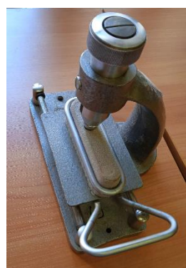
Рис. 2. Схема та зовнішній вигляд приладу ПТ–2 для визначення стійкості кольору до стирання
