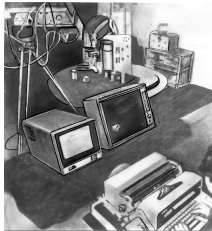
Рис. 6. Експериментальний електромеханічний робот ЕТЛ-1 (Японія), 1971 р.
