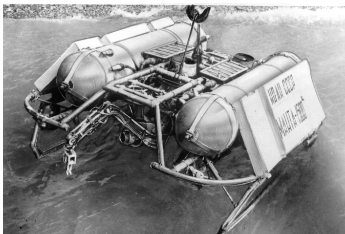
Рис. 3. Робот з технічним зором і маніпулятором керованим від ЕОМ «Манга», 1971 р., (Росія).
