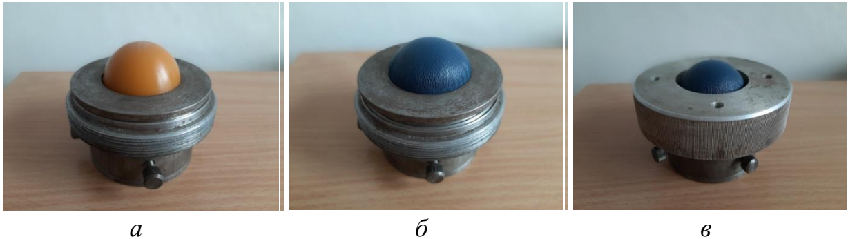
Рис. 2.2. Пластиметричний пристрій для об'ємного формування шкіряних матеріалів: а – основа з пластмасовою півсферою; б – основа з пластмасовою півсферою із зтягнутим зразком шкіри; в – основа з пластмасовою півсферою із зтягнутим та зафіксованим зразком
