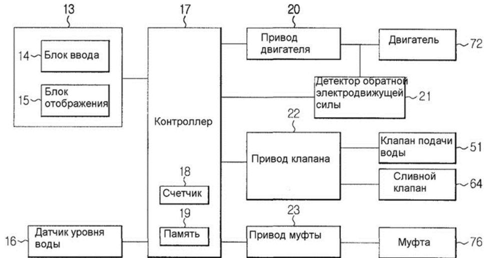
Рис. 2.2. Структурна схема контрольного блоку пральної машини
