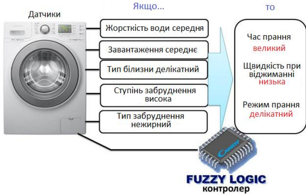
Рис. 1.9. Прийняття рішення системою управління набором значень вхідних параметрів
