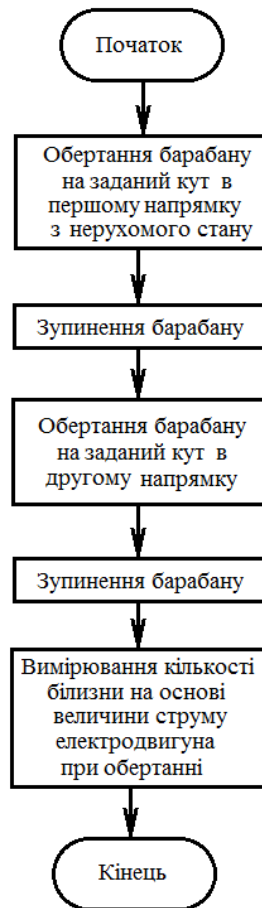
Рис. 3.3. Алгоритми управління приводом пральної машини при визначенні маси білизни
