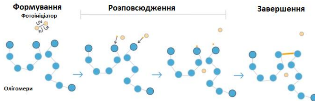
Рис. 1.10 Стадії процесу полімеризації в адитивному виробництві.
