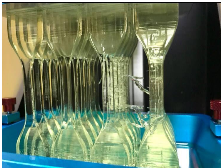
Рис. 3.13 Вироби для дослідження фізико-механічних властивостей
