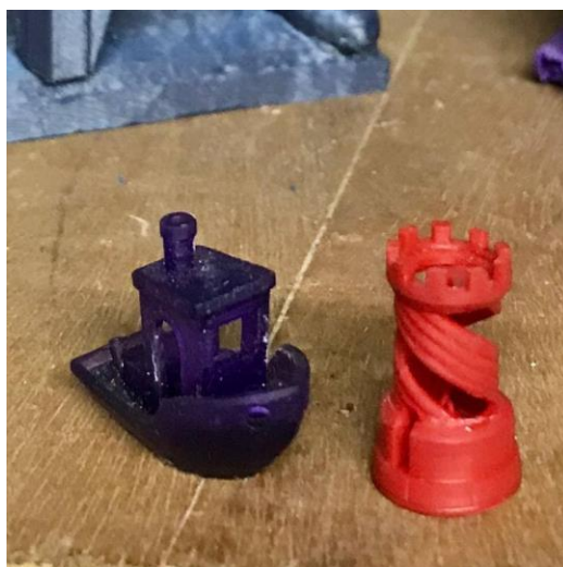
Рис. 3.12 Вироби отримані 3D друком методом SLA з складною просторовою структурою.
