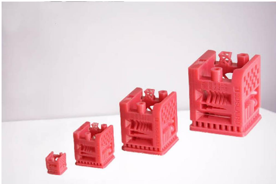
Рис. 3.11 Тестова модель для підбору параметрів 3D друку SLA
