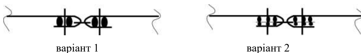
Рисунок 3.1 – Графічне зображення обробки рельєфних швів пілочок та спинки куртки жіночої з НШ (варіант 1 та 2)
