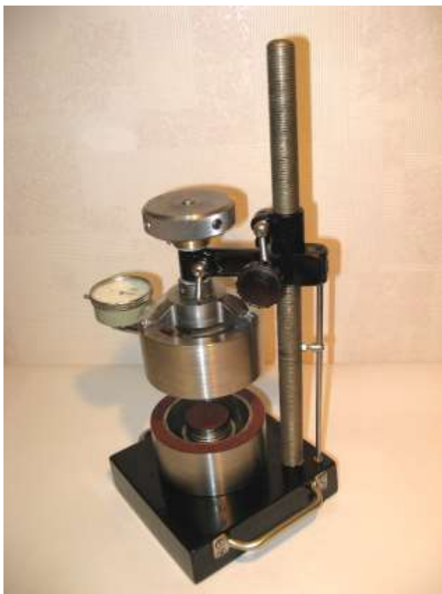
Рисунок 2.6 - Пристрій для визначення механічних властивостей матеріалів методом зсуву
