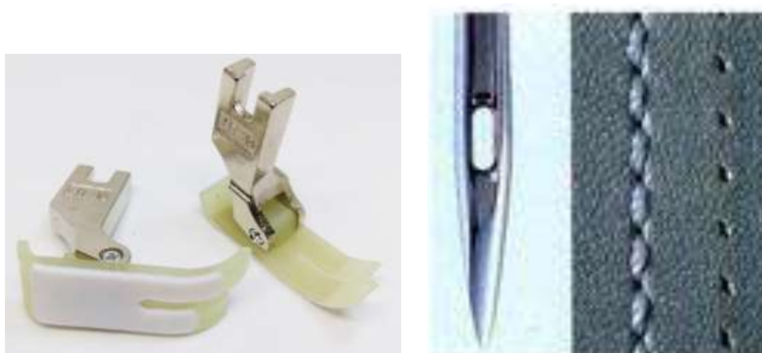
Рисунок 3.4 – Вигляд тефлонової лапки та вигляд заточення вістря голки.
