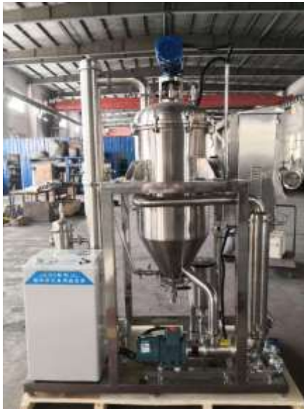
Рис. 2.8. Загальний вигляд та схема кристалізатору з рамною мішалкою: А – подача розчину, Б – відведення сокової пари, В – відведення кристалічної суспензії, Г – подача гострої пари, Д – відведення конденсату; 1 – корпус, 2 – сорочка обігрівальна парова, 3 – мішалка, 4 – привід мішалки
