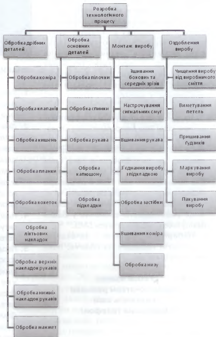
Рис. 2 – Технологічна схема виготовлення куртки для екстремального туризму
