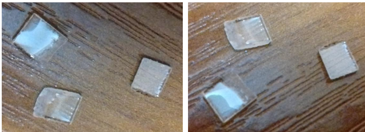
Рис.1 – Загальний вигляд полірованих пластин склоподібного тетраборату літію
