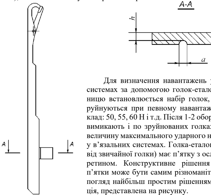
Рис. 1. Голка-еталон для визначення навантажень у в'язальних системах
