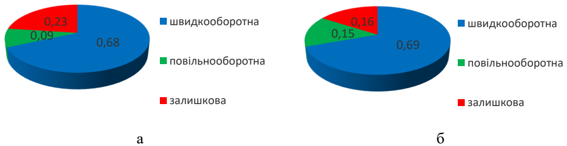
Рис. 3. Складові частки повної деформації зразка 2: а) вздовж петельних рядів; б) вздовж петельних стовпчиків
