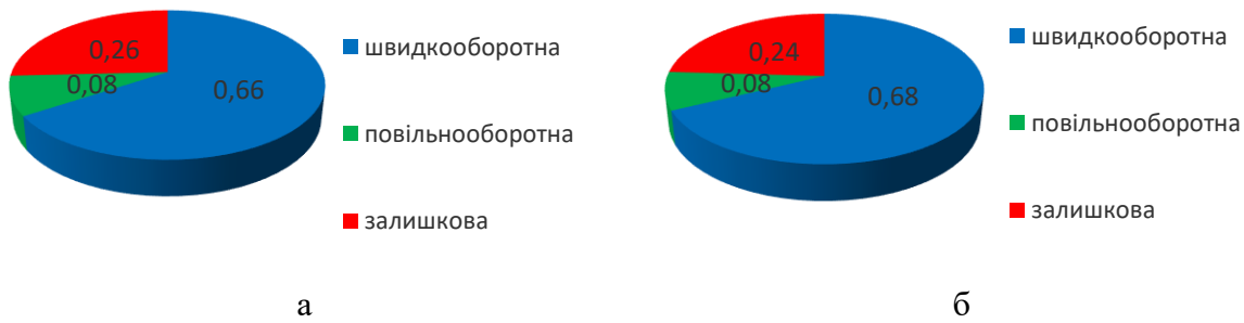
Рис. 6. Складові частки повної деформації зразка 5: а – вздовж петельних рядів; б – вздовж петельних стовпчиків
