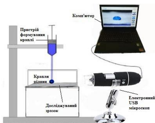
Рис. 5. Схема визначення крайового кута змочування
