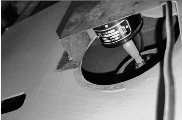
Рис. 5. Зовнішній вигляд потенціометра теплостійкого прецизійного, що було включено до електричної схеми дільника напруги та з'єднано гнучким валом з віссю стрілки динамометра випробувальної розривної машини УММ-5
