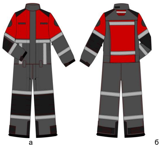
Рис. 11. Загальний вигляд аварійно-рятувального комбінезону для локалізації аварійних ситуацій: а – вигляд спереду, б – вигляд ззаду
