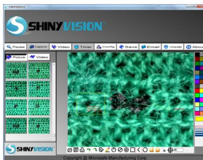
Рис.2. Макрофотографія зразка трикотажу переплетення ластик 2+2 при розтязі по ширині 80% у контрольній точці 5
