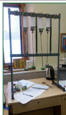
Рис. 1. Релаксометр типу стійка. Проведення досліджень деформаційних властивостей
